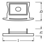
**Technische Daten Ledvance LED Streifen Abschlusskappe Hole für PM05**
