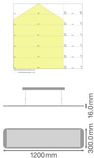
**Technische Daten Ledvance LED Panel Pendelleuchte 36W 4000lm - 840 | 120x30cm - Dali Dimmbar - Direct/Indirect - UGR <19**
