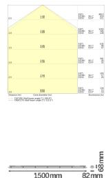
**Technische Daten Ledvance LED Feuchtraumleuchte Feuchtigkeitsdicht 26W 3500lm - 840 | 150cm - Bewegungs- Und Lichtsensor - Ersatz Für 58W**
