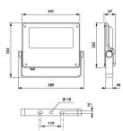
**Technische Daten Philips LED-Scheinwerfer Coreline BVP125 Grau 95W 12000lm 9-41x102D - 740 | IP66 - Asymmetrisch**
