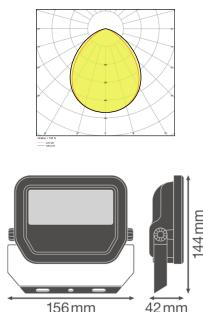
**Caractéristiques Ledvance Projecteur LED GEN 3 Noir 20W 2200lm 100D - 830 | IP65 - Symétrique - Remplacement 50W**
