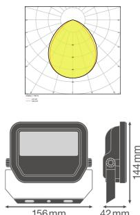
**Caractéristiques Ledvance Projecteur LED GEN 3 Blanc 20W 2200lm 100D - 830 | IP65 - Symétrique - Remplacement 50W**
