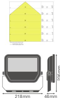
**Caractéristiques Ledvance Projecteur LED GEN 3 Noir 50W 6000lm 100D - 840 | IP65 - Symétrique - Remplacement 100W**
