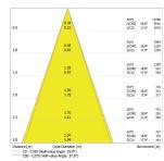
**Caractéristiques Ledvance Downlight LED Surface IP65 Aluminium Blanc 15W 1575lm 36D - 830 Blanc Chaud | IP65**
