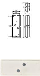
**Caractéristiques Philips LED Sécurité Ledinaire WL055V Blanc 8W 630lm - 840 | 374x150mm - IP65 - Éclairage De Secours 3 Heures**
