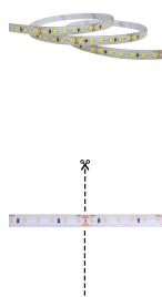
**Caractéristiques Rubans LED Naga 5 Mètre 24V - 120LEDs/m - 9.6W/m - 965 | 8mm - IP65 - Meilleur Rendu De Couleur - SMD2835**
